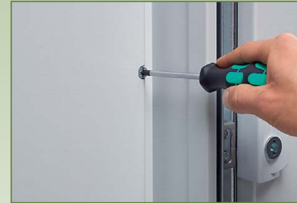
System szybkiego mocowania przedniej pokrywy
